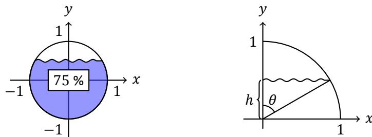
Vis at når vannet fyller 75 % av røret, så løser  $\theta$  ligningen
