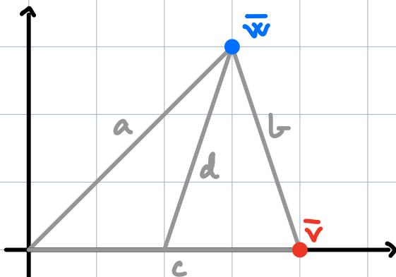
$$\|\bar{w}\| = a ; \quad \|\bar{v}\| = c ; \\ \|\bar{w} - \bar{v}\| = b$$
